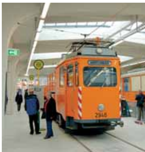
Služební motorový vůz na opravu troleje.
