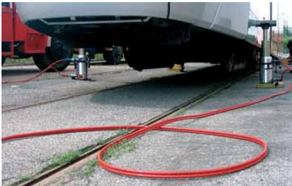
Příd tramvaje zdvižená pomocí zvedáků HP25/T450R a manipulačních trnů.
