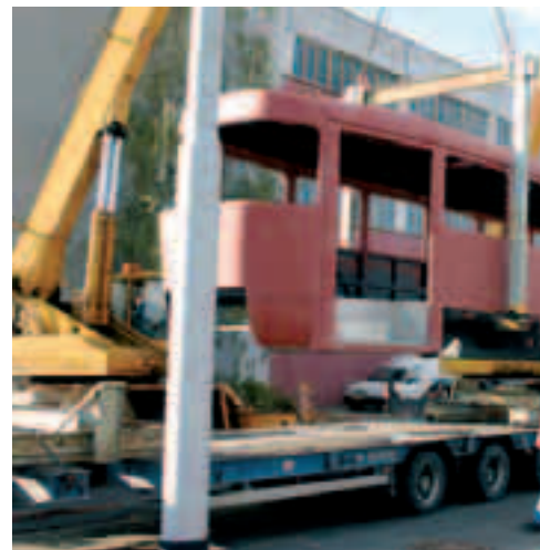
Skládání skříně pro tramvaj T3R.PLF č. 8252 odpoledne 2. listopadu 2006 na tzv. jalové podvozky.
