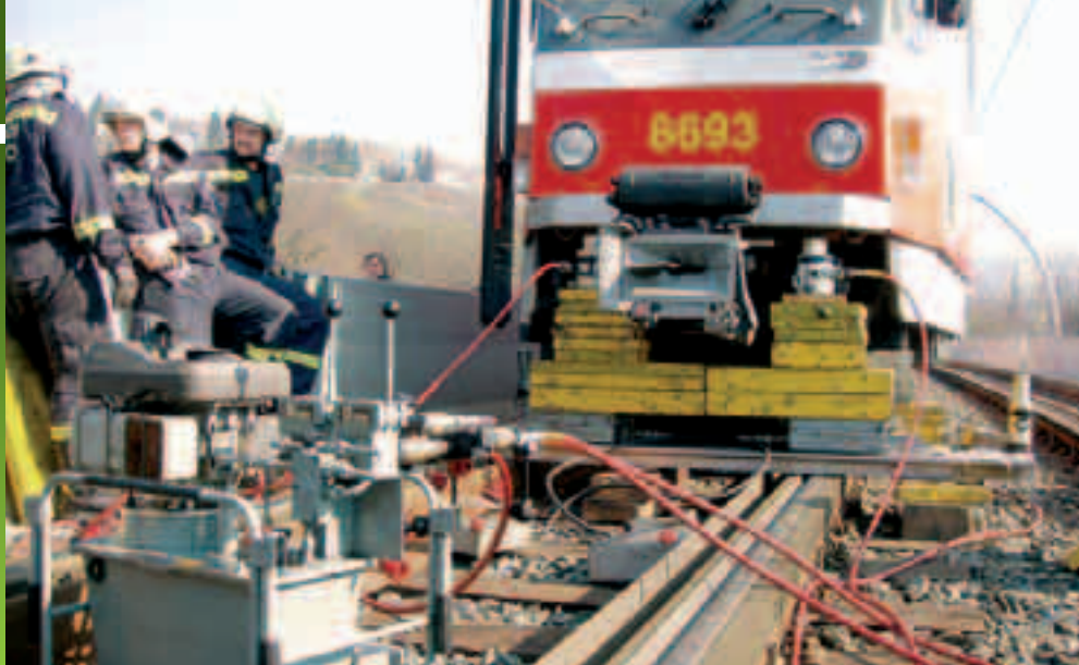
Zařízení LUCAS, pomocí kterého se provádí nakolejení vozu, bylo použito na tramvaji typu T6 poprvé.
