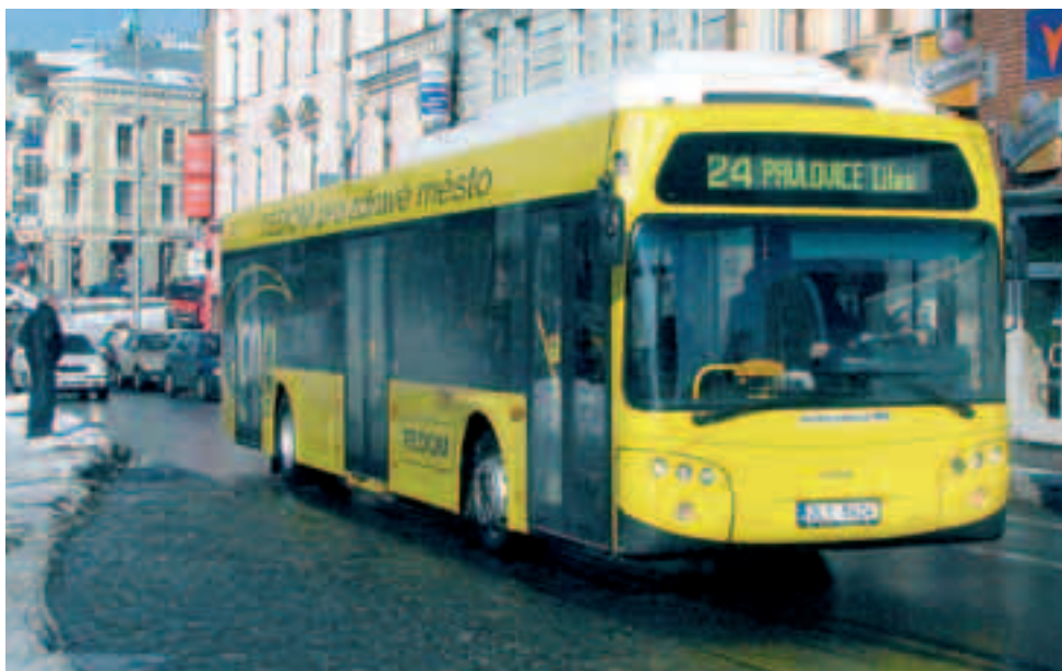
Nízkopodlažní autobus TEDOM s plynovým pohonem smluvního dopravce ČSAD Liberec na lince MHD.
