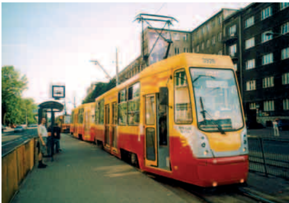
Vlak složený z modernizovaných vozů 2x805N Konstal. Zadní vozy slouží jako motorizované vleky, z důvodu zvýšení kapacity nemají stanoviště řidiče.
