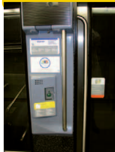
Na sloupku vedle dveří pro výstup a nástup cestujících je umístěno zařízení pro obousměrnou komunikaci cestujícího s vlakovým dispečerem. Cestující zmáčkne zelené tlačítko a může začít hovořit s vlakovým dispečerem.
