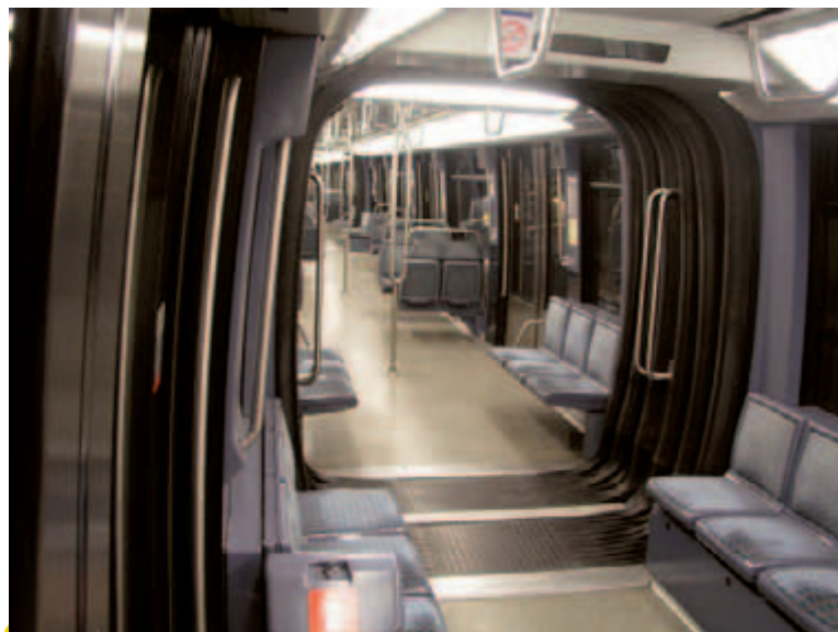
Průchod mezi dvěma vozy linky č. 14. Povšimněte si podlouhlého zrcadlovitého pásku nad průchodem. Jedná se o polopropustné zrcadlo, za kterým je kamera monitorující prostor pro cestující.
