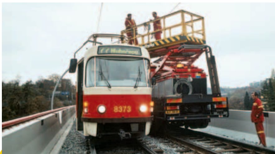
Na nové trati bylo zapotřebí vyzkoušet i zásah „dráteníků“. Co kdyby došlo k poruše trolejového vedení, nebo se některé tramvaji porouchal pantograf? Pomocí kolejového adaptéru se automobil vrchního vedení dostane snadno i na tramvajovou trať na samostatném tělese s otevřeným svrškem, barrandovskou estakádu nevyjímaje.
