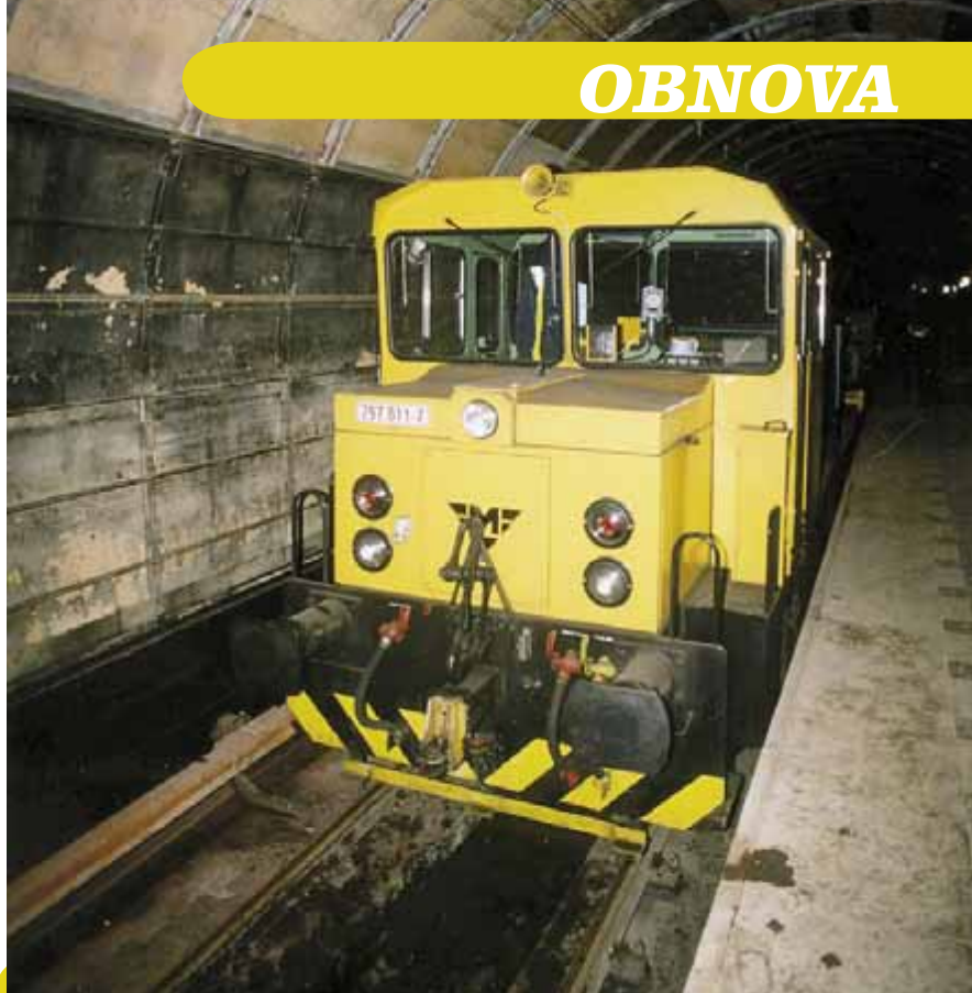
V době naší návštěvy ve stanici Náměstí Republiky stál v kolejišti lokotraktor, který zajišťuje odvoz poškozeného materiálu ze stanice.
