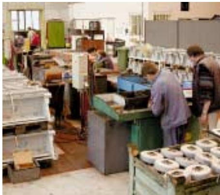
Hala oprav v depu Kačerov – kompletace stupňů pohyblivých schodů.
